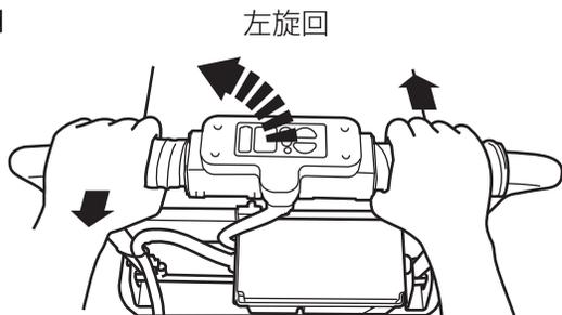
③ 旋回する場合は通常台車と同様の操作で、曲がりたい側のセンサーグリップを引いて、反対のセンサーグリップを押して操作します。【図 17】
