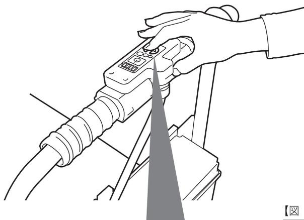
①操作パネルのスピード調整ボタン（上下）でスピードを調整してください。【図 11】
