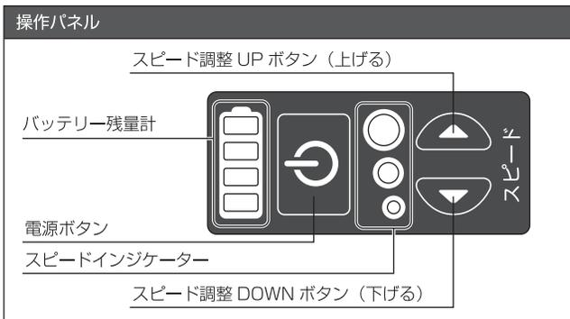
異常検知時はスピードインジケータのLEDの点滅箇所により、異常内容をお知らせします。
