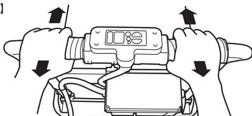
②電源が入っていることを確認し、センサーグリップを両手でしっかり持って、通常の台車を動かすように感覚的に台車を操作します。【図 15】
