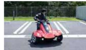
右の手元にあるスイッチを押しながらアクセルを操作することで、簡単にバック走行ができます。駐車に便利です。
