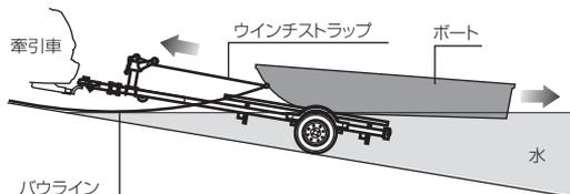
③ウインチフックに手が届く位置まで進水させてフックを外してからボートをパウラインを使用して傾斜路から離れた位置に移動させた後、牽引車でトレーラーを引き上げてください。
