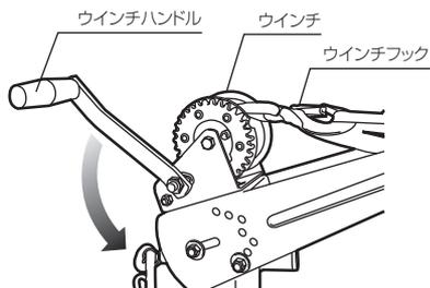
ラチェットレバーを戻し、ウインチフックをボートのパウアイにかけてウインチハンドルを下図の矢印の方向に回してボートを固定してください。また固定はウインチだけに頼らず、必ずタイダウンベルトでの固定をおこなってください。
