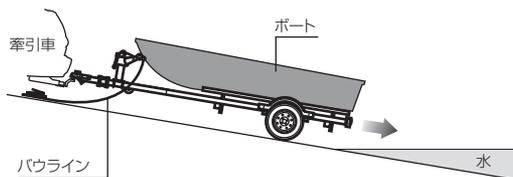
①まずはじめに進水させるスロープを確認してください。未舗装で路面が湿っている場合は、滑りやすくなっています。ボートにパウラインを取り付け、トレーラーを固定していたタイダウンベルト、トレーラーの配線プラグを外し、進路に人がいないことを確認後傾斜路へバックさせてください。
